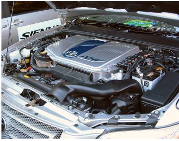
Figura 5.3: Vano motore del prototipo Toyota Fuel-Cell <sup>[21]</sup>
