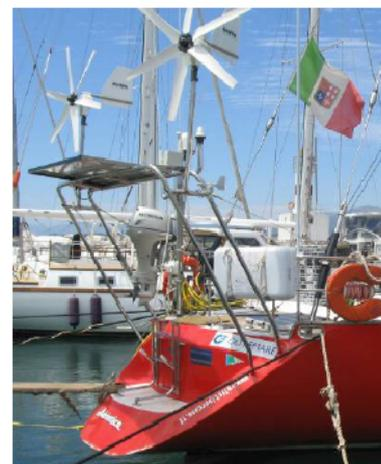
Figura 5.9: Foto del pannello FV e degli aerogeneratori installati sulla roll-bar <sup>[33]</sup>
