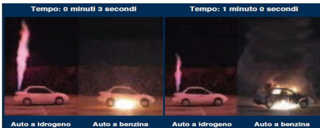
Figura 5.1: Simulazione di incendio di un'auto a idrogeno e a benzina <sup>[7]</sup>
