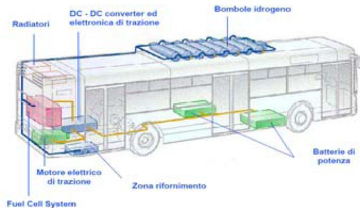
Figura 5.7: Schema del CityClass Fuel Cell <sup>[15]</sup>
